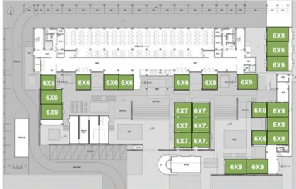
■ 6m×6mの標準化されたモジュールで多機能変換を素早く実現
