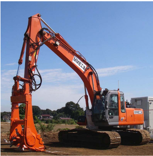
地盤改良機全景
