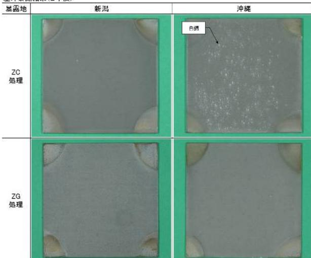
び6価クロムが用いられている。しかし、近年、環境への関心が高まり、RoHS 指令(電気・電子機器に含まれる特定有害物質の使用制限に関するEU指令)等で有害物質の使用が制限されている(6価クロムの閾値は1,000ppm)ことから、ZAMめっき(高耐食溶融亜鉛-6%アルミニウム-3%マグネシウムめっき)の化成処理として、3価および6価クロムを用いず、他の金属にて同様の防錆効果(耐白錆性)を有するZC 処理(無機系クロメートフリー処理)を開発した。また、有機系樹脂にて同様の防錆効果(耐白錆性)を有するZG 処理(有機系クロメートフリー処理)も開発した。
